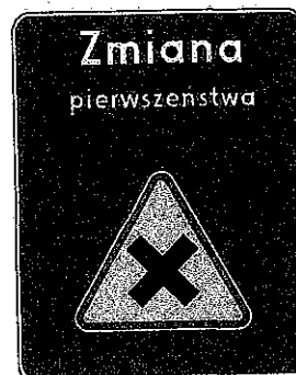
Rys. 5.2.54.1. Znak D-48 wskazujący skrzyżowanie dróg równorzędnych
